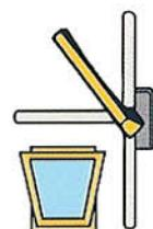
Zvláštní poloha kliky pro provedení se štěrbínovým větráním
